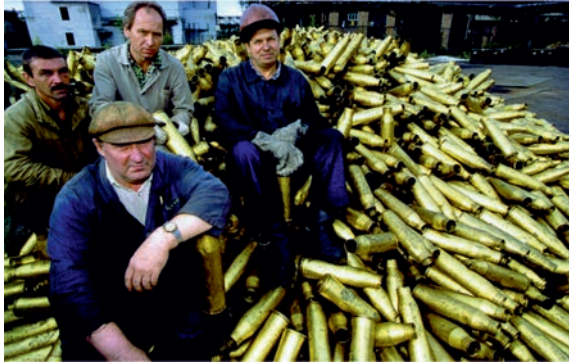
Рис. 8.27. Гильзы артиллерийских снарядов, позднее переплавленные для изготовления латунных поглотителей адронных калориметров установки CMS [13]
