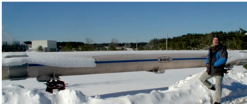
Рис. 7.17. Внешний вид дипольного магнита коллайдера RHIC. Справа: доктор физико-математических наук, начальник сектора ЛФВЭ А. Г. Литвиненко
