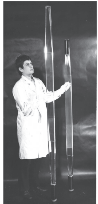
Рис. 8.5. Сцинтилляционные детекторы в виде полос на полистирольной основе
